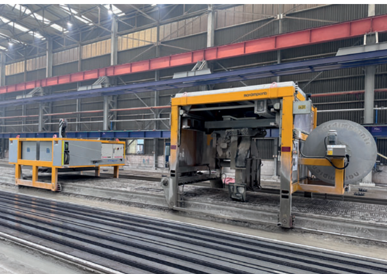
Автоматическая многоугольная пила в комплекте с тележкой с противовесом
