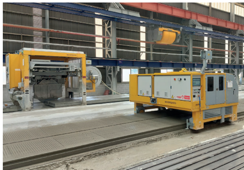
Автоматический плоттер и многоугольная пила, работающие в полностью автоматическом режиме
